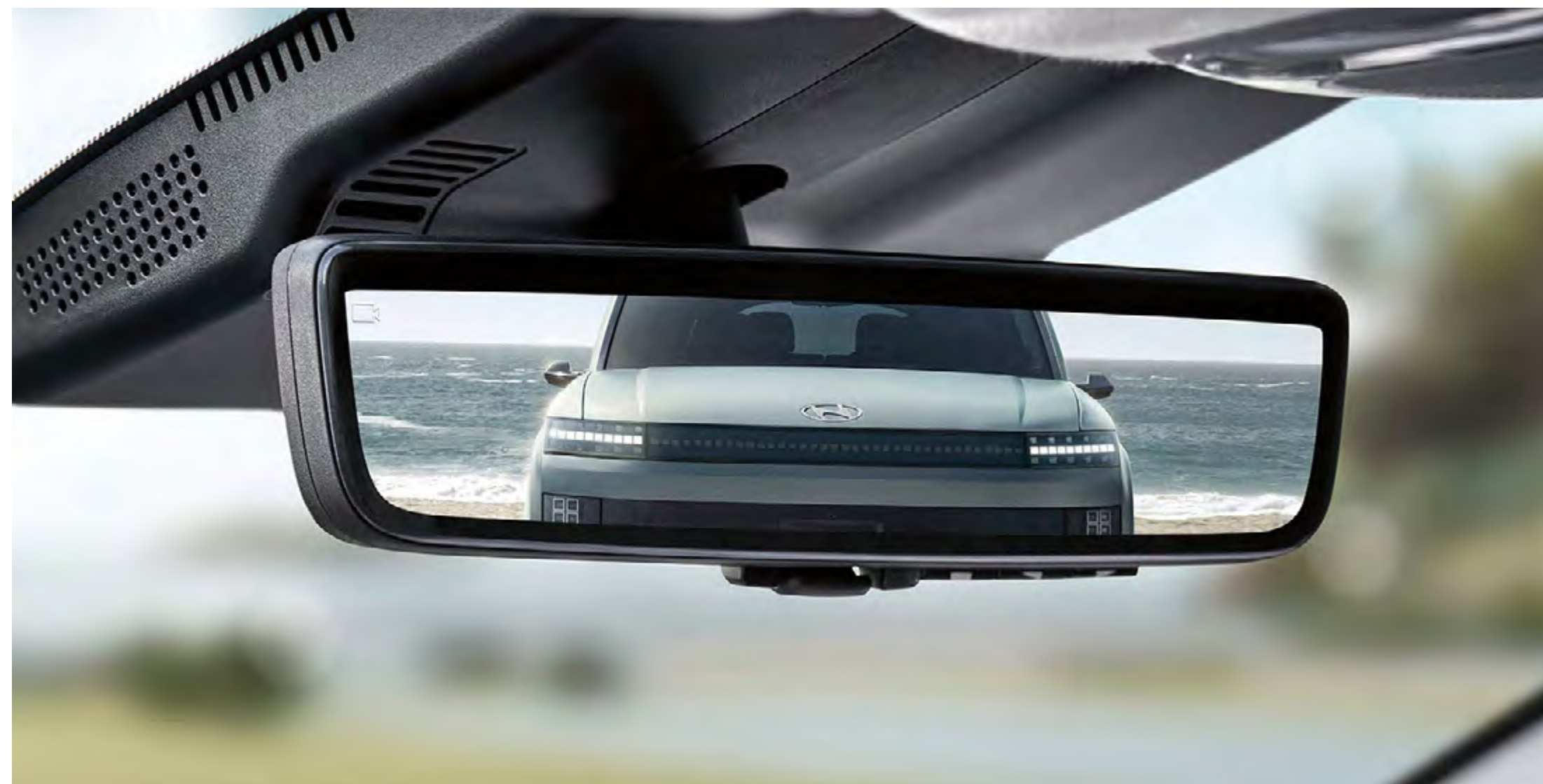
Quando ativado, o Espelho Central Digital utiliza uma câmara traseira para projetar uma imagem de vídeo em tempo real no espelho, proporcionando um campo de visão muito mais amplo.
