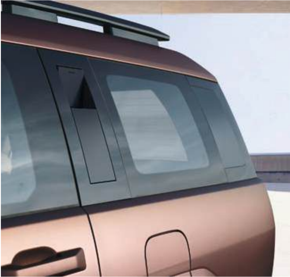
Pega de Assistência no Pilar C.
