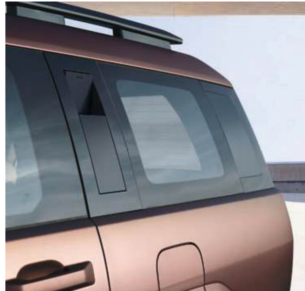
Pega de Assistência no Pilar C.
