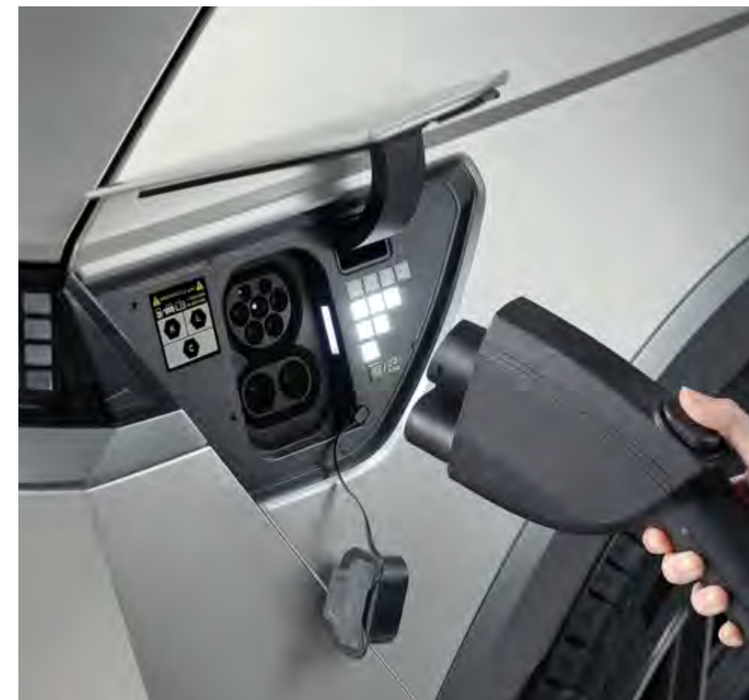
Tampa de carregamento eléctrico
