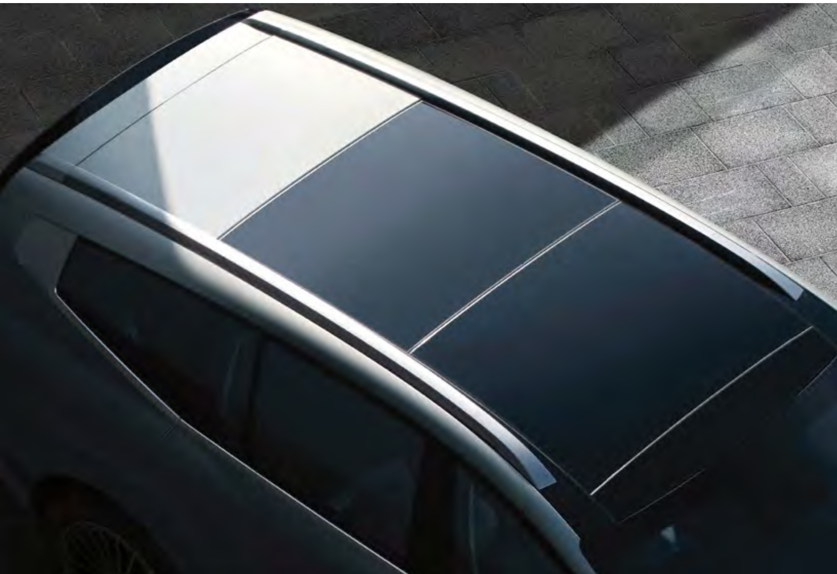
Tejadilho aerodinamicamente otimizado, com antenas ocultas e teto panorâmico de abertura.
