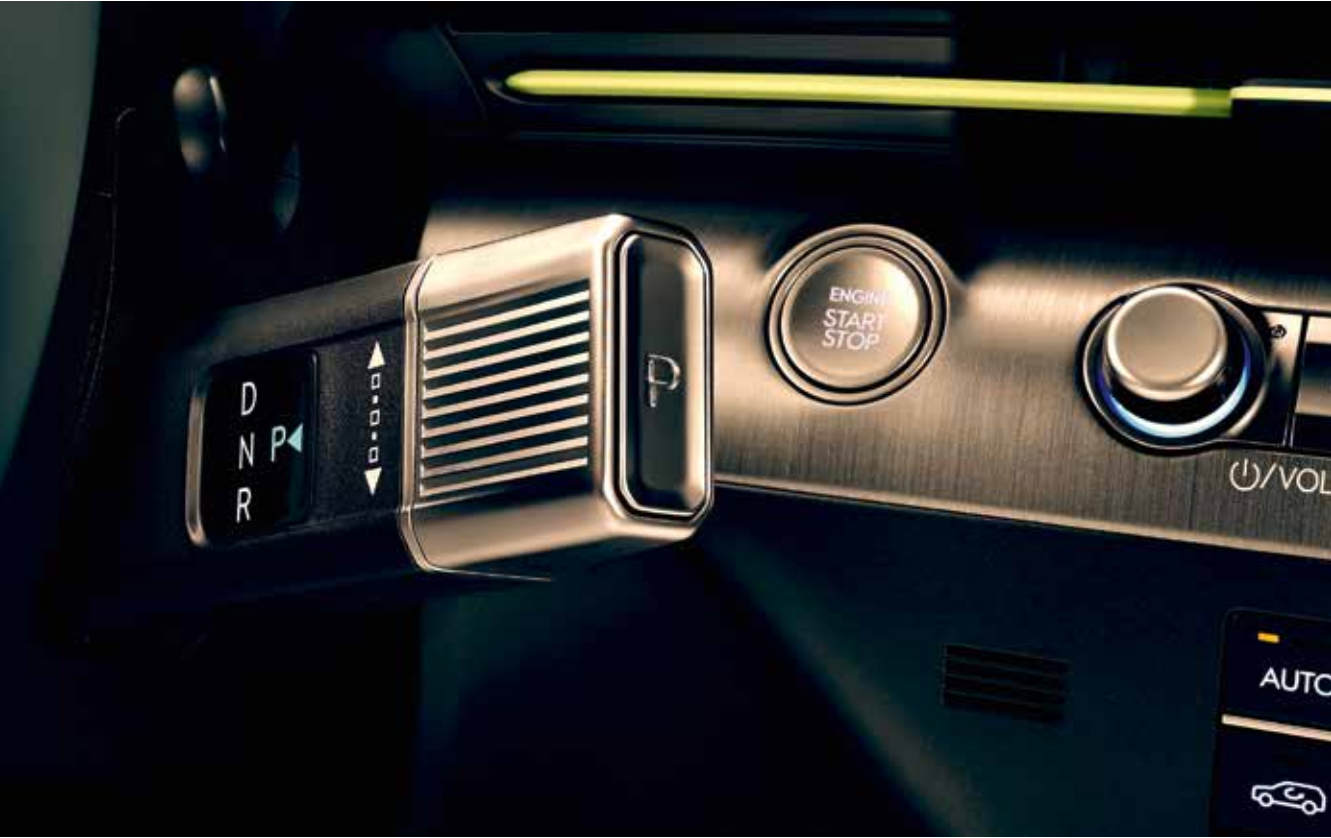
Seletor de velocidades Shift-by-Wire montado na coluna de direção.
