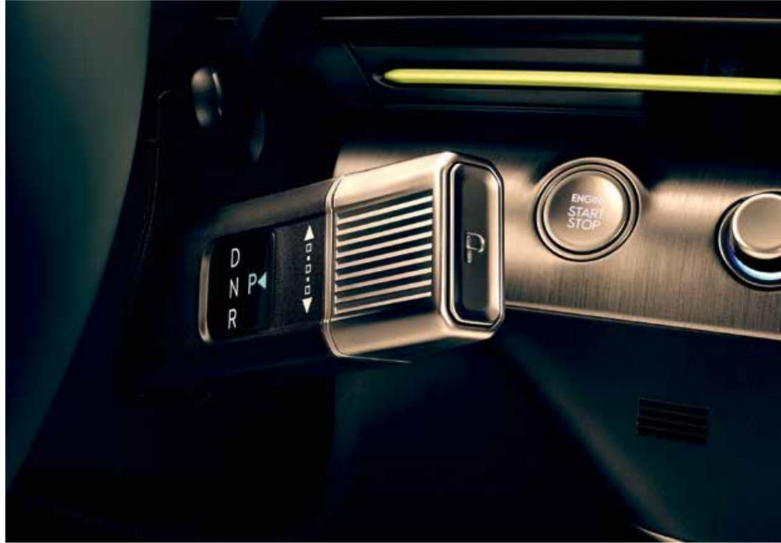
**Seletor de velocidades Shift-by-Wire montado na coluna de direção.**
