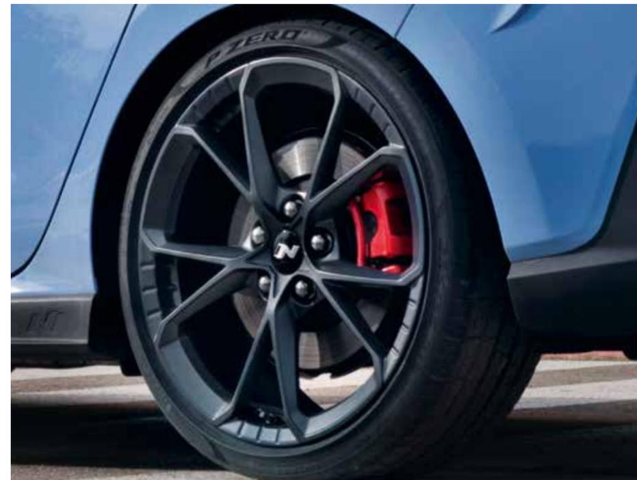
A estreia das novas jantes forjadas de 19" melhoram a condução e tração através da redução de peso desnecessário. Estão integradas com os pneus de alta-performance Pirelli P-Zero.
