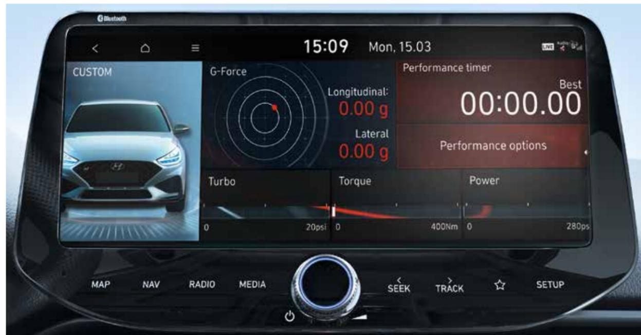
O Performance Driving Data System permite monitorizar e melhorar a dinâmica de condução com novos gráficos de fácil utilização e com informação da potência, binário, turbo, forças G e tempos por volta.
