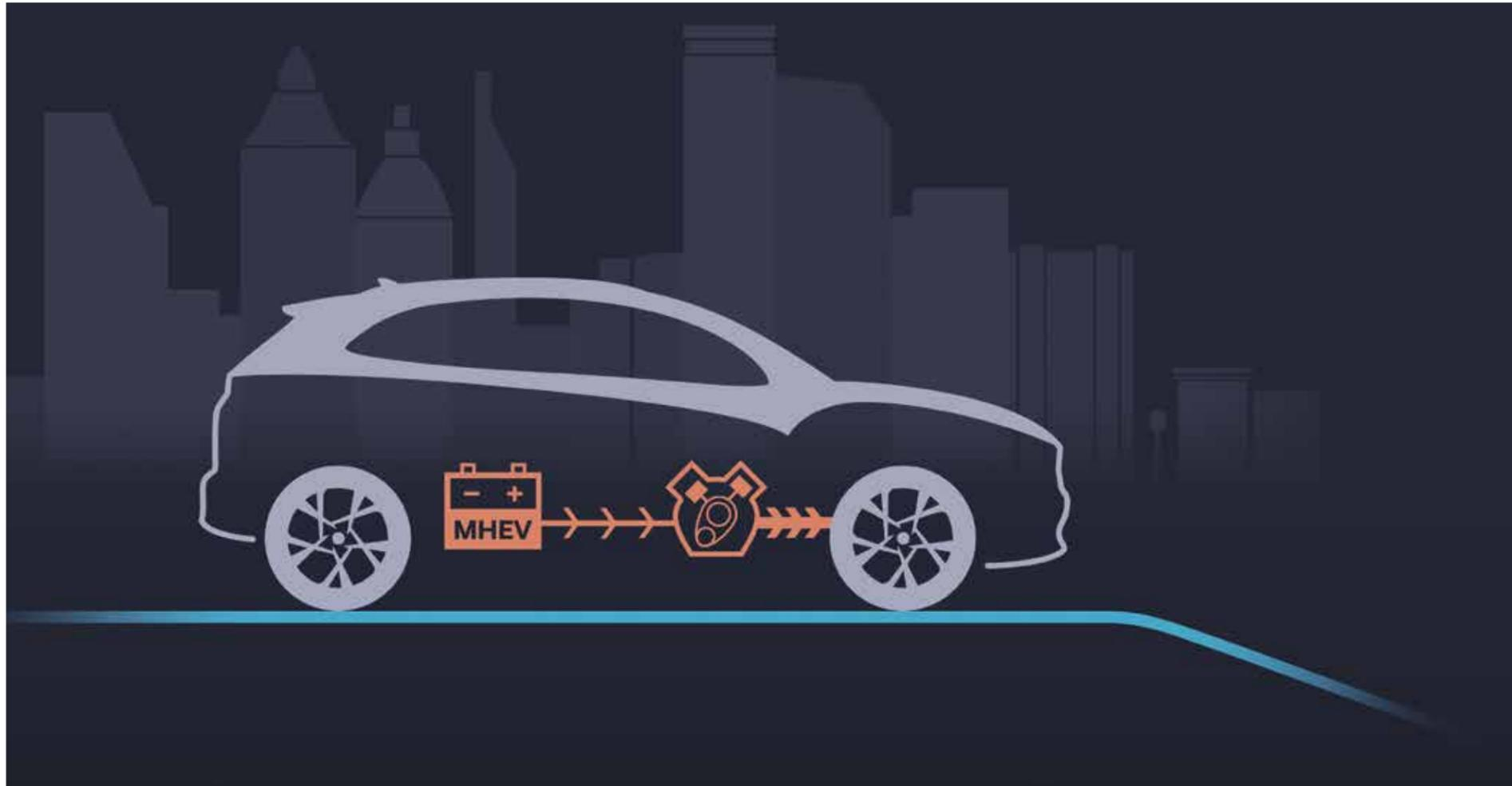
Poupar combustível e reduzir as emissões de CO2 nunca foi tão fácil. O sistema 48-volt mild hybrid suporta o motor a combustão com binário adicional durante a aceleração de modo a reduzir os consumos e as emissões de CO2. A bateria é carregada durante a condução através da travagem
