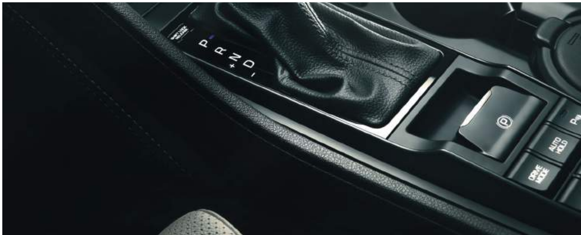
Travão de mão elétrico – Situado abaixo da caixa de velocidades.
