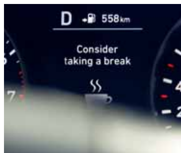
Alerta de Fadiga do Condutor (DAA) deteta indícios da fadiga do condutor e emite alertas sonoros e visuais.
