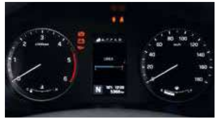
Indicador de AdBlue Indica-lhe rapidamente uma aproximação da quantidade de AdBlue disponível no tanque.
