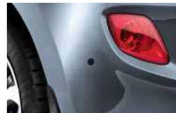
**Sensores de estacionamento traseiros.** Para facilitar o estacionamento em espaços apertados. O tom de alerta muda conforme a proximidade a obstáculos.
