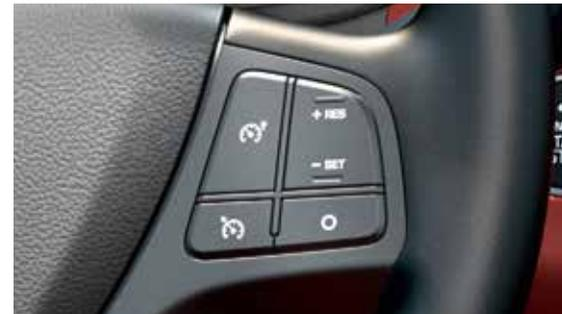
**"Cruise Control" com limitador de velocidade.** Este sistema irá permitir-lhe conduzir descansado sabendo que não irá, por distração, ultrapassar a velocidade que definiu.
