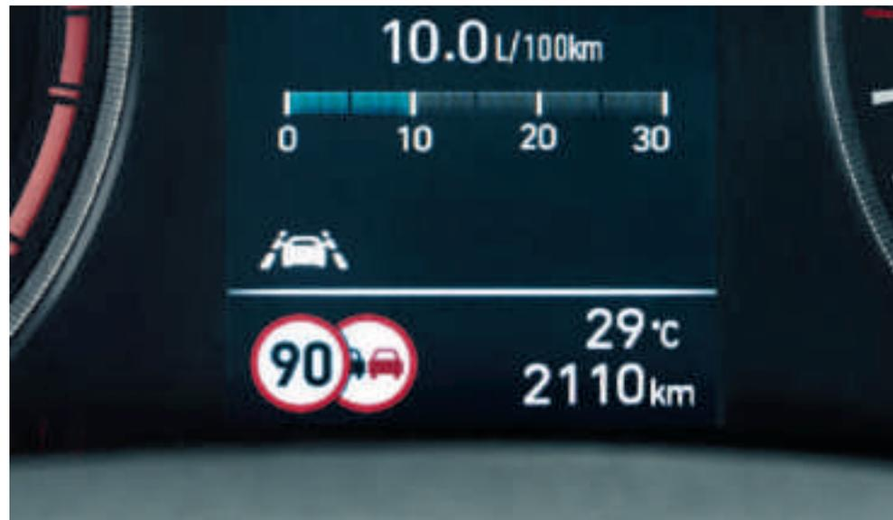
Sistema de Informação da Velocidade Máxima (ISLW). O Sistema de Informação da Velocidade Máxima utiliza a câmara frontal e informações do sistema de navegação para identificar sinais de trânsito e de limite de velocidade em tempo real. As informações são exibidas no ecrã "supervision".
