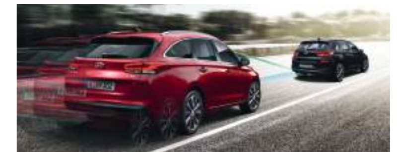
Travagem autónoma de emergência (AEB) aplica automaticamente uma travagem parcial ou total caso seja detetada uma potencial colisão.
