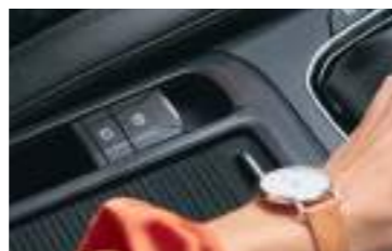
Travão de parque elétrico**
