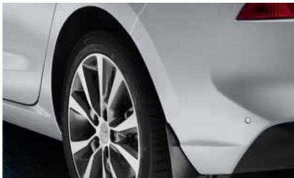
**Guarda-lamas traseiro.** Estes guarda-lamas desenhados especificamente para o novo i30 proporcionam uma proteção adicional ao fundo do carro, são a melhor solução para evitar ter terra, salpicos de lama e pedras a danificar partes importantes do carro.
