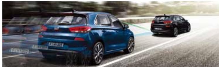
**Travagem autónoma de emergência (AEB)** Ao detetar um veículo adiante este sistema aplica automaticamente uma travagem parcial ou total caso seja detetada uma potencial colisão.
