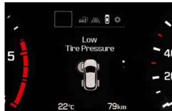
**Sistema de monitorização da pressão dos pneus (TPMS).** Deteta e indica a perda de pressão nos pneus.
