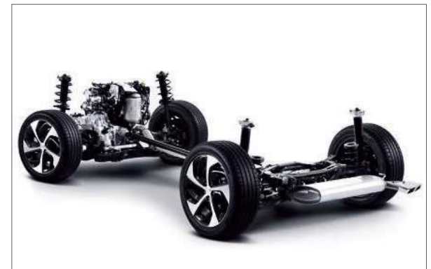
Tração 4X4. Quando uma possível perda de tração é detetada, até 50% do binário é transferido para as rodas traseiras para melhorar a aderência em superfícies escorregadias. A distribuição do binário pode ser bloqueada no modo 50:50 para lidar com condições extremas.
