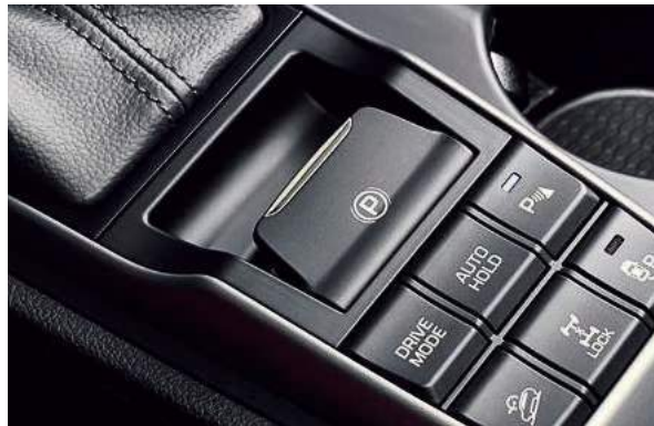
Travão de mão elétrico (EPB). O compacto travão de mão elétrico liberta espaço útil no interior, entre os lugares da frente, traz conveniência graças à sua função de cancelamento automático.
