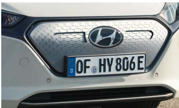
As entradas de ar ativas integradas na grelha dianteira abrem e fecham automaticamente para otimizar a aerodinâmica nas três motorizações.
