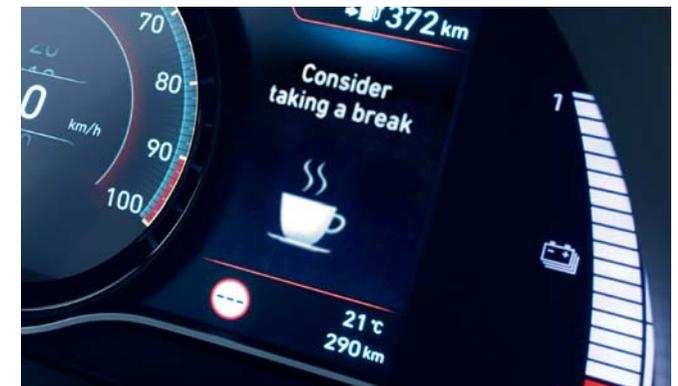
**Alerta de Fadiga do Condutor (DAW).** O sistema DAW eleva os padrões de segurança e conforto a um novo nível, ao monitorizar e analisar continuamente os padrões de condução. Quando o sistema deteta fadiga ou distração no condutor, emite um alerta sonoro ou uma mensagem que sugere a travagem.
