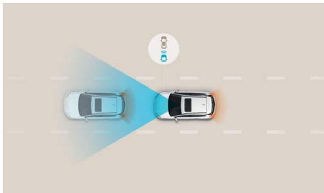
**Travagem Autônoma de Emergência (FCA).** O sistema FCA usa a câmara dianteira e o radar dianteiro para monitorizar possíveis obstáculos no percurso. No caso de detetar uma possível colisão com um veículo ou pedestre alerta o condutor e, caso seja necessário, abranda ou trava a viatura.
