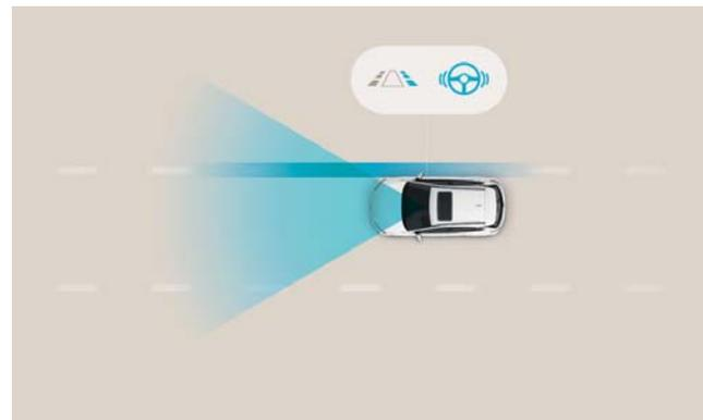
**Sistema de Manutenção à Faixa de Rodagem (LKA).** O LKA usa a câmara dianteira para monitorizar as marcações da estrada. No caso de uma saída de faixa não intencional o sistema alerta o condutor e aplica uma ligeira força no volante para direccionar a viatura de volta para a faixa.
