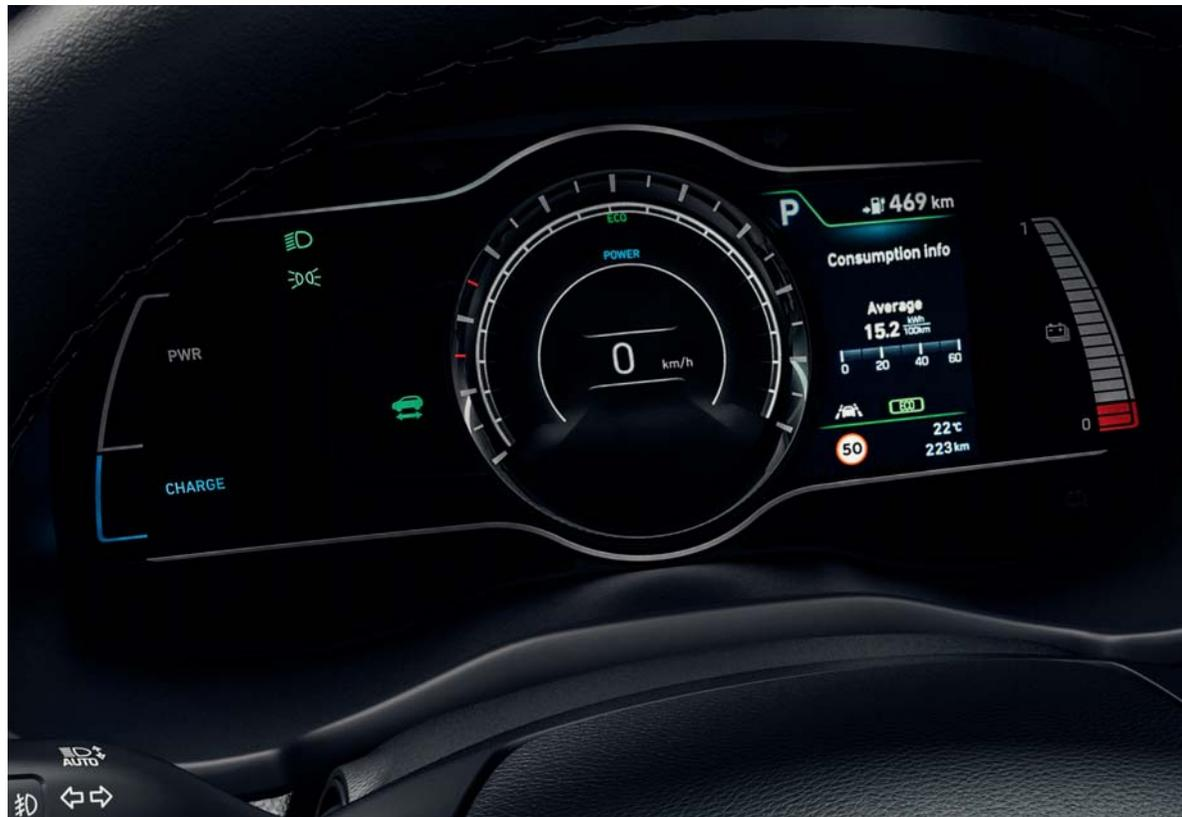
**Painel de instrumentos digital de 7"** – O painel de instrumentos digital indica o modo de condução e o fluxo de energia e estado das baterias. Basta um olhar para teres toda a informação que necessitas.
