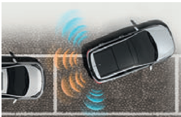
Sensores de estacionamento. Sensores traseiros facilitam o estacionamento em locais apertados.
