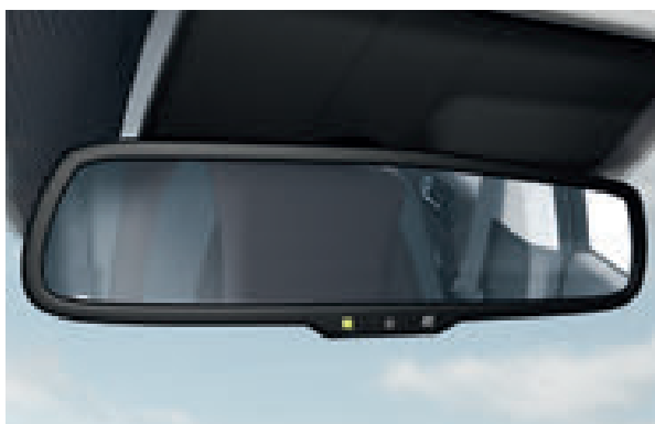
Espelho interior electrocromático (ECM). O espelho interior escurece automaticamente sempre que detetar o brilho dos faróis de uma viatura que esteja na sua retaguarda.
