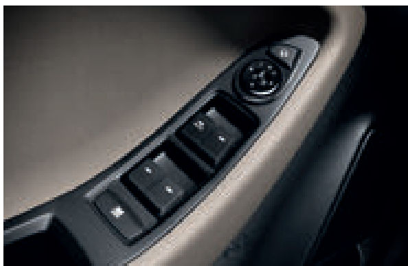
Vidros elétricos em todas as portas. A porta do condutor vem equipada também com a função automática e anti-entallamento.
