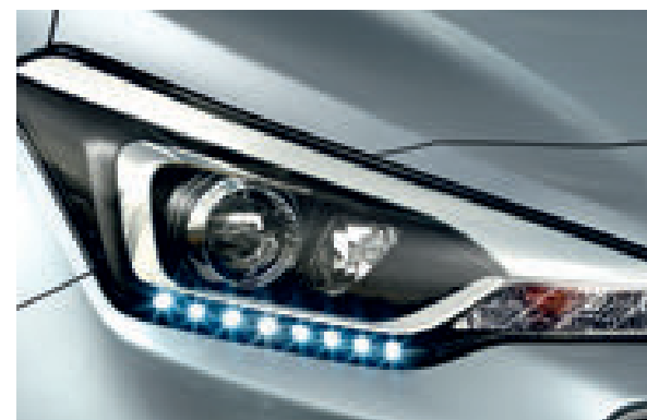
Óticas de dupla projeção. Em combinação com os LEDs diurnos e a luzes de curva.
