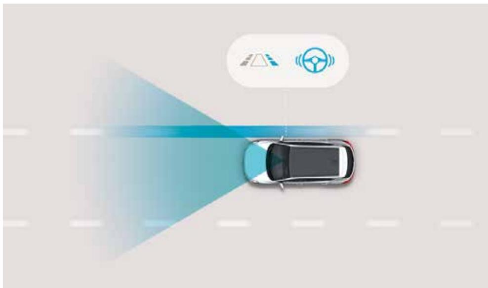
**Sistema de Assistência à Faixa de Rodagem (LKA)\*.** Este sistema utiliza a câmara frontal para monitorizar a faixa de rodagem. No caso de ocorrer uma saída não intencional da faixa de rodagem, o sistema alerta o condutor e corrige o sentido da direção do veículo.
