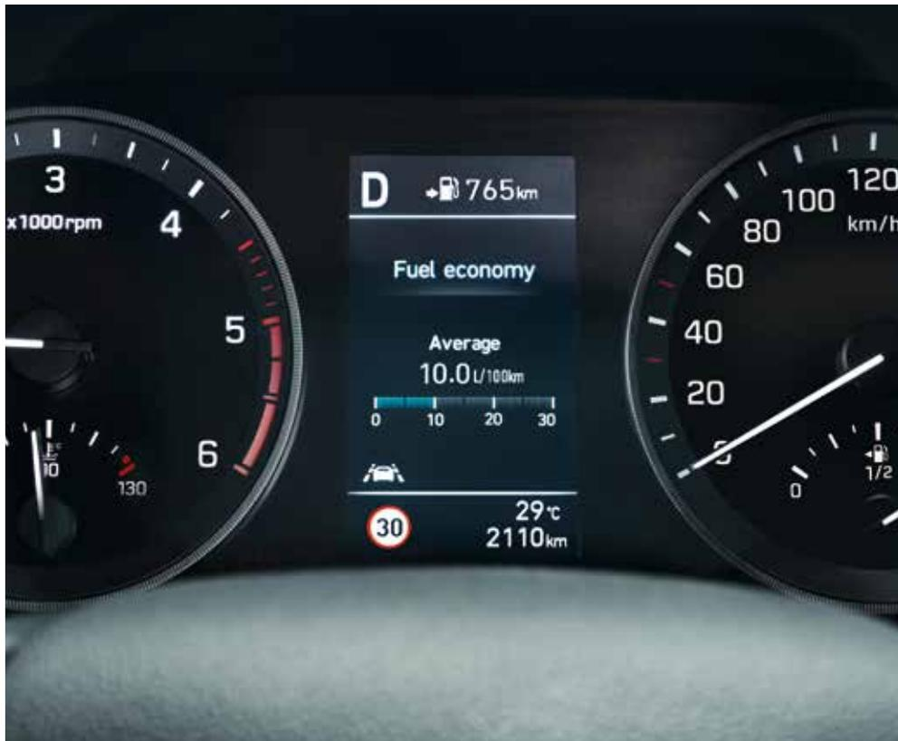
**Painel de instrumentos “Supervision”\*** – Otimamente posicionado e de fácil leitura, o painel de instrumentos “supervisão” com ecrã LCD colorido de 4,2” mostra informações importantes sobre o condutor como: equipamentos de segurança ativos, alcance restante, consumo de combustível, instruções de navegação, temperatura externa e muito mais.
