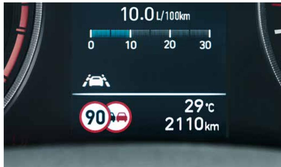
**Sistema de Informação da Velocidade Máxima (ISLW)\*.** O Sistema de Informação da Velocidade Máxima utiliza a câmara frontal e informações do sistema de navegação para identificar sinais de trânsito e de limite de velocidade em tempo real. As informações são exibidas no ecrã "supervision".
